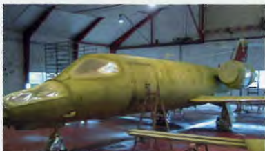
Der neue Learjet wird lackiert
