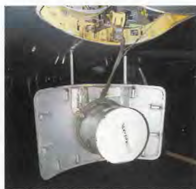
Der Bremsschirm in seiner aufgeklappten Halterung im Rumpf des LAR-Jets
