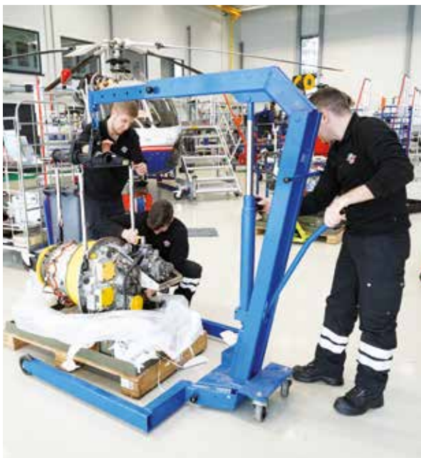
Die Techniker heben das Triebwerk eines Hubschraubers an.
